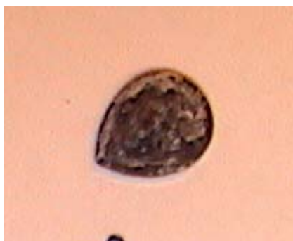
شکل‌های ۴ و ۵: نمونه تورمالین قبل از تابش بعد از ۷۲ ساعت تابش دهی در راکتور
