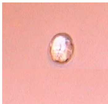
شکل‌های ۷ و ۶: نمونه کوارتز قبل از تابش نمونه کوارتز بعد از ۲۴ ساعت تابش، کوارتز دودی
