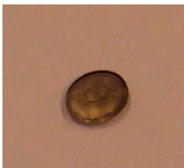
شکل‌های ۷ و ۶: نمونه کوارتز قبل از تابش نمونه کوارتز بعد از ۲۴ ساعت تابش، کوارتز دودی
