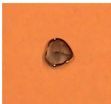
شکل‌های ۸ و ۹: نمونه توپاز قبل از تابش نمونه توپاز بعد از تابش
